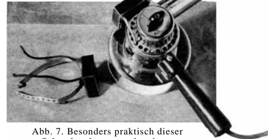
Abb. 7. Besonders praktisch dieser Schutzkondensator mit seinem Befestigungsband.
