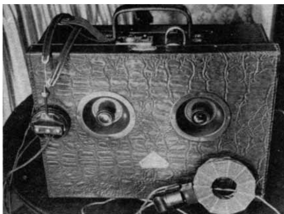
Vorne liegt die Tastantenne. Oben ist der ringförmige Ein- und Ausschalter zu sehen.
